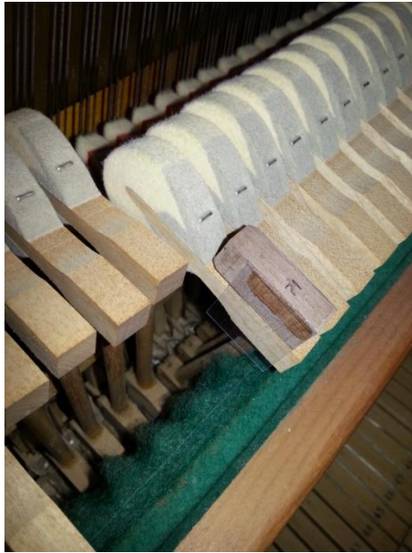
(写真1) ハンマーストライクレシオを求めるために載せた2.0gのおもり
