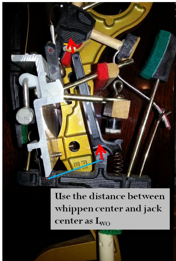
（写真5）ウイペンとハンマー間のギアレシオを求めるために、ウイペン側の出力距離を求める。
