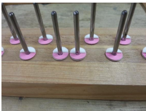
(写真14) 半分にカットされたクロスをペーパーパンチング（写真ではピンク色）に接着する
