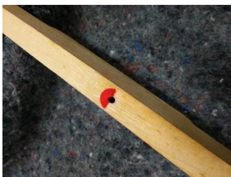
(写真13) 半分にカットされたクロスを鍵盤裏面に貼る
