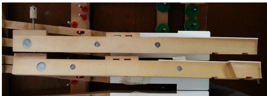
(写真6) 鍵盤前後に同じ鍵盤鉛を入れて慣性モーメントを増やす
