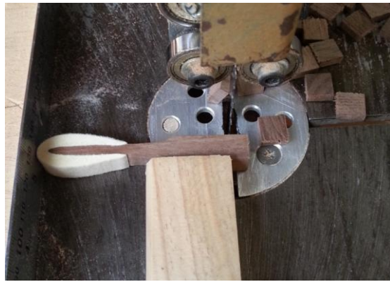
(写真9) バンドソーでテールを切断している様子。写真ではシャンク接着前のものを加工している。
