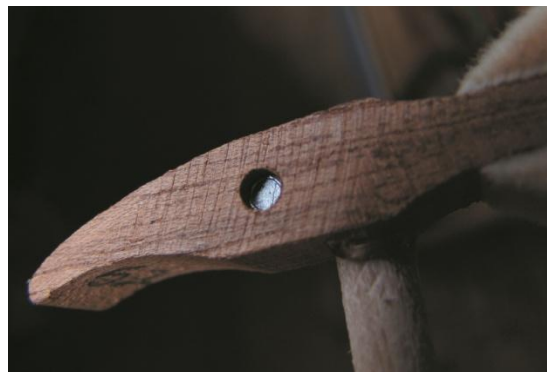
写真1：ハンマーウッドに埋められたハンマー用鉛
